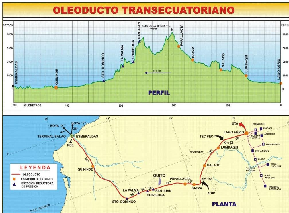
El Sistema del Oleoducto Transecuatoriano (SOTE) constituye una de las obras de infraestructura más importantes del Ecuador. Tiene una capacidad de transporte de 360.000 BPPD para crudo de mínimo 23,7°API, 78.8 cSt. de viscosidad a 80° F y 390.000 BPPD utilizando químico reductor de fricción.
