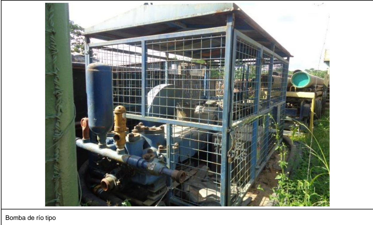
Figura 3-11 Bombas que se prevé Utilizar para la Captación de Agua
