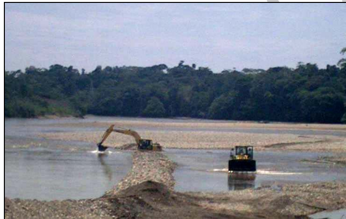
Foto 4- 3. Mina Aguarico 3. Extracción del material pétreo para las plataformas
